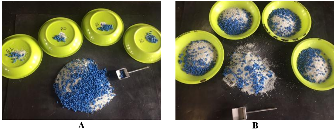
Figura 17 - Método de pazada alternada
