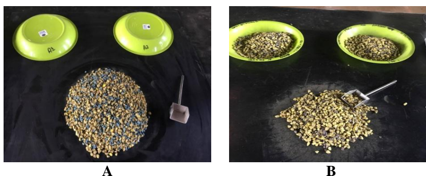
Figura 16 - Divisão do material por pazada alternada
