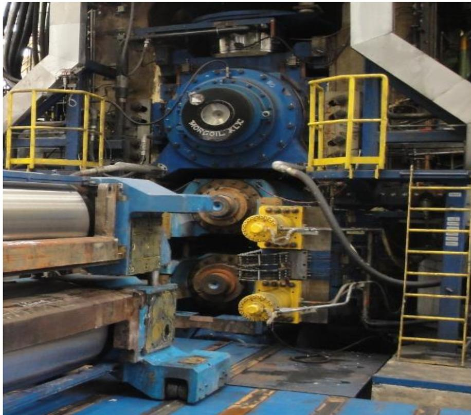
Figura 9 – Cilindro de laminação inserido no laminador
