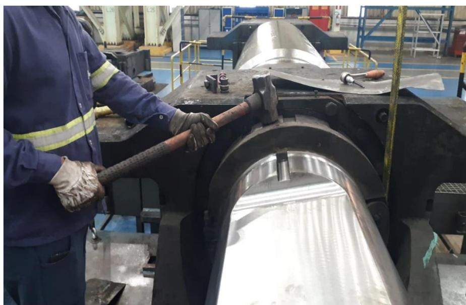
Figura 18 – Montagem do cilindro de laminação
