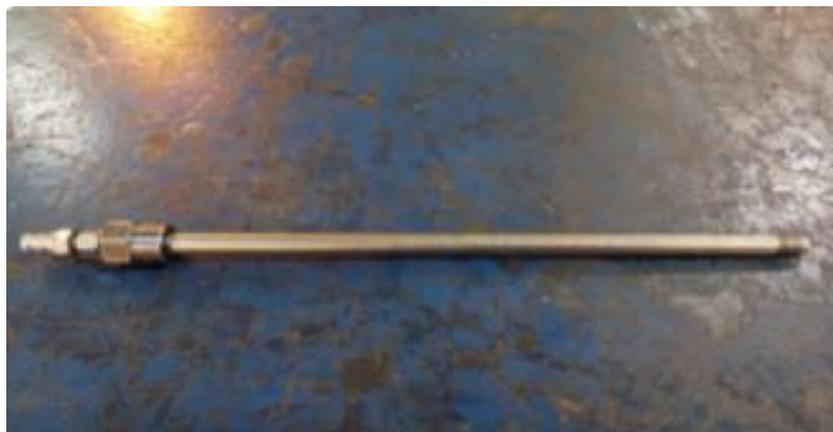
Figura 25 – Tubo para acionamento da porca hidráulica
