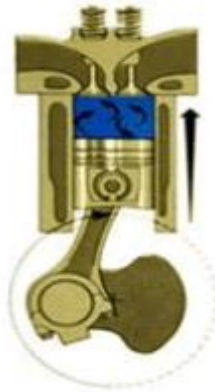
Figura 5: Compressão da mistura ar-combustível ciclo Otto. Fonte: Silva (2008).
