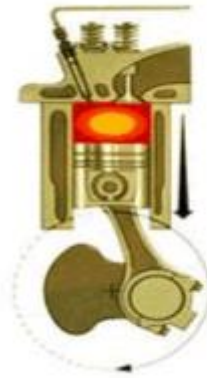
Figura 6: Combustão da mistura ar-combustível ciclo Otto. Fonte: Silva (2008).
