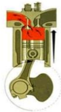
Figura 7: Exaustão dos gases ciclo Otto. Fonte: Silva (2008).
