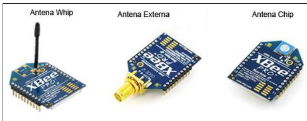
FIGURA 3 – Tipos de Antena para módulos Xbee. Fonte: DIGI, 2011. Adaptado pelo autor.
