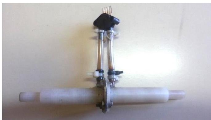
**Figura 3.9 Protótipo do medidor de vazão**
