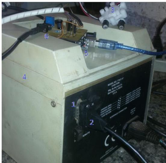
**Figura 4.1. Vista posterior da bomba acoplada com a *shield*. (1) Conector Fêmea DB9. (2) Conector Fêmea DB9. (3) Sensor de Fluxo. (4) Bomba Peristáltica. (5) Arduino. (6) *Shield***
