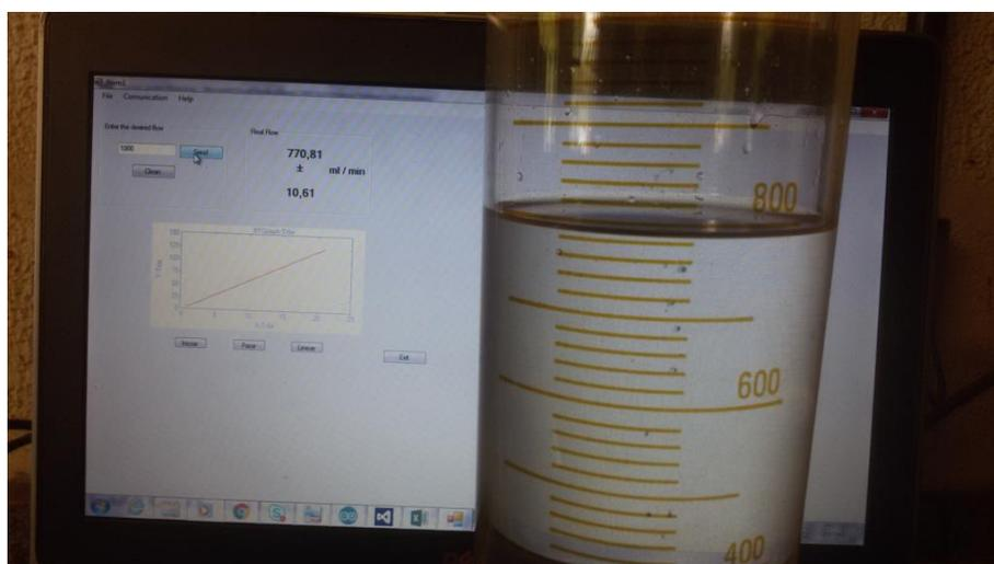
Figura 4.3. Medição com vazão com 1000 ml/min
