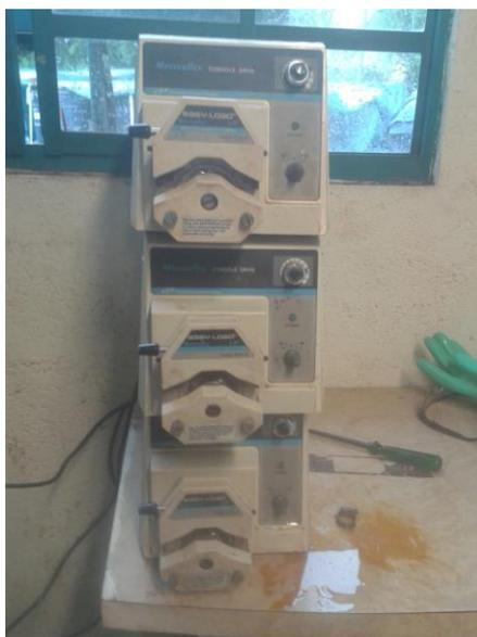
**Figura 2.8 Bomba Peristáltica MasterFlex**
