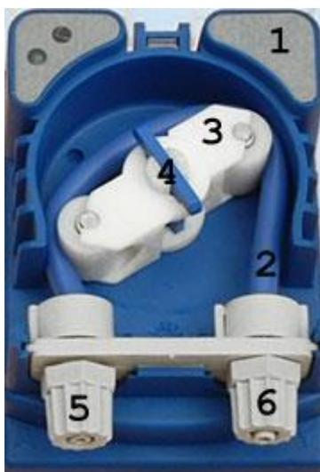
**Figura 2.9 Vista interna do cabeçote de uma bomba peristáltica**
