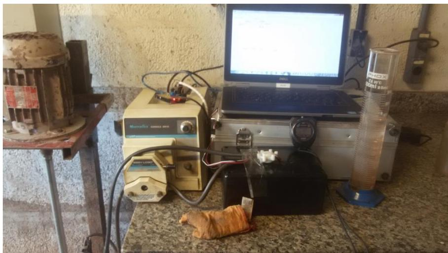
**Figura 4.2. Montagem da bomba acoplada com *shield* e sensor**
