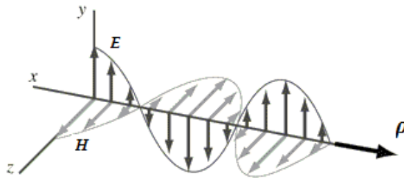
Figura 6 – Propagação tridimensional de ondas eletromagnéticas (Modificado de WETZEL (2014)).
