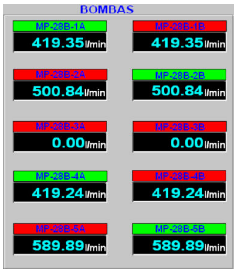
Figura 4.28 – Estado das bombas e indicação da vazão do underflow dos cinco espessadores
