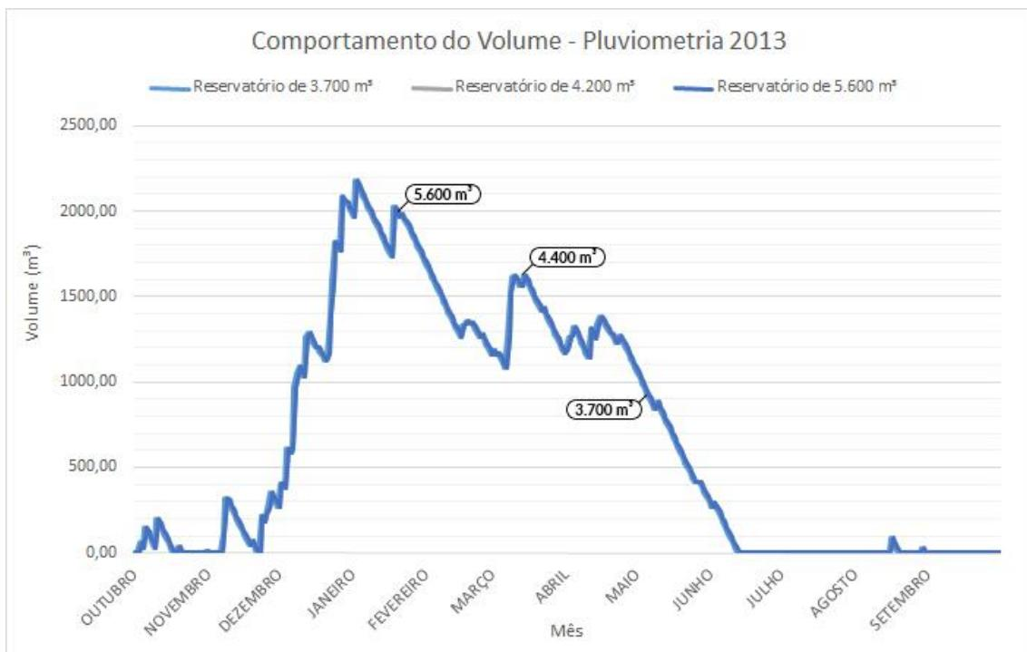
Figura 19 - Comportamento do volume armazenado nos reservatórios com a pluviometria do ano hidrológico de 2013 e com volume inicial nulo
