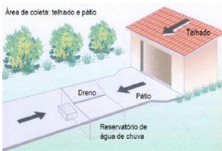
Figura 6 - Área de Coleta: telhado e pátio com armazenamento subterrâneo (MAY, 2004)
