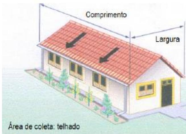
Figura 5 - Área de Coleta: telhado (MAY, 2004)
