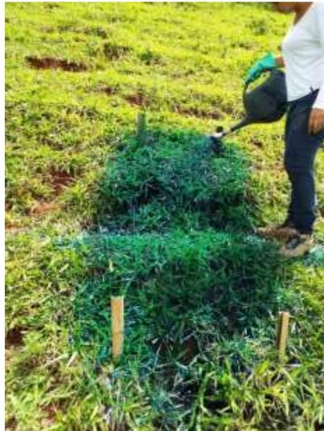
**Figura 3.2** - Aplicação do traçador no solo em área de  $1 \text{ m}^2$ . Itaverava (Arquivo Pessoal).
