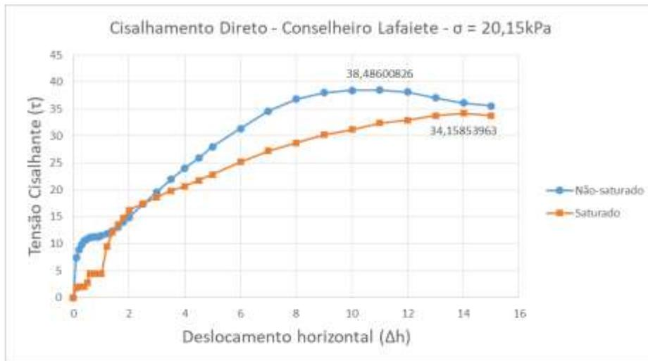
Figura 4.12 - Gráfico da resistência ao cisalhamento do solo, submetido a uma tensão normal de 20,15kPa.
