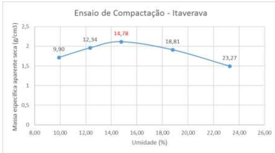
**Figura 4.19** - Ensaio de compactação - Itaverava.
