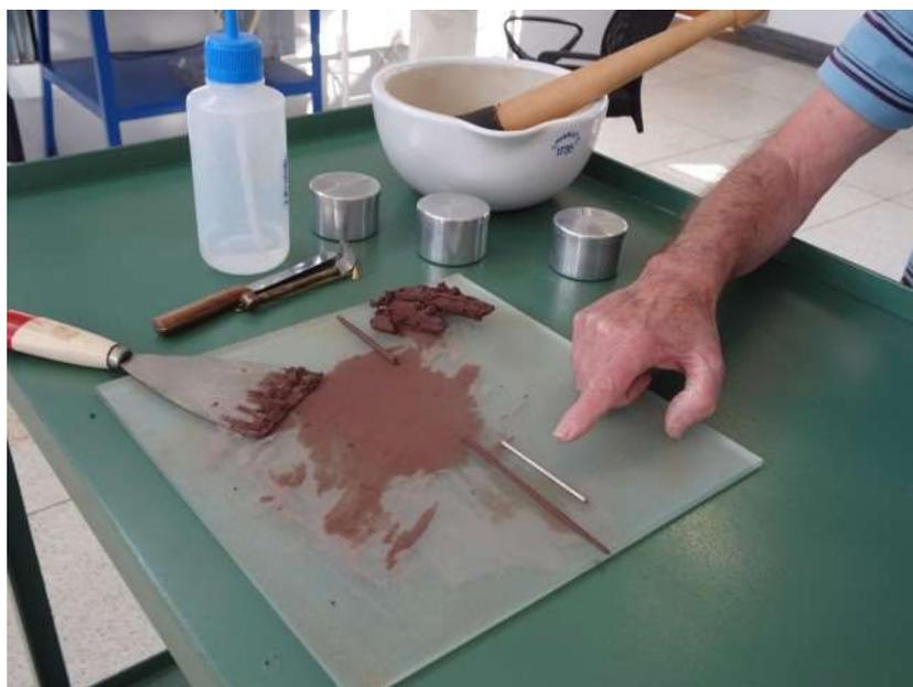
**Figura 3.9** - Ensaio de Limite de Plasticidade (Fonte: Torres Geotecnia).
