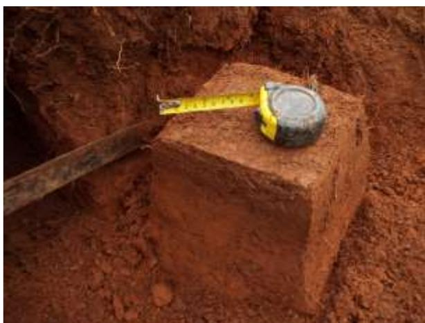
**Figura 3.1** - Coleta de amostra indeformada em campo (Arquivo pessoal).
