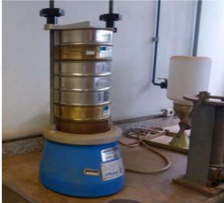
**Figura 3.7** - Peneiras usadas para o peneiramento fino, no agitador (Arquivo pessoal).
