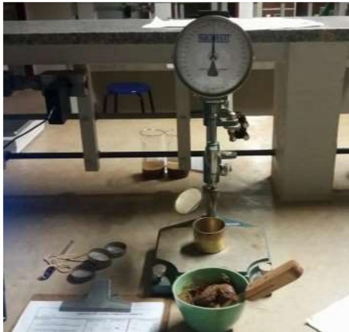
**Figura 3.8** - Cone britânico utilizado para o teste do Limite de Liquidez (Arquivo pessoal).
