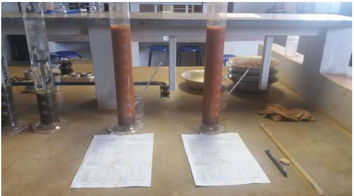
**Figura 3.6** - Ensaio de sedimentação (Arquivo pessoal).
