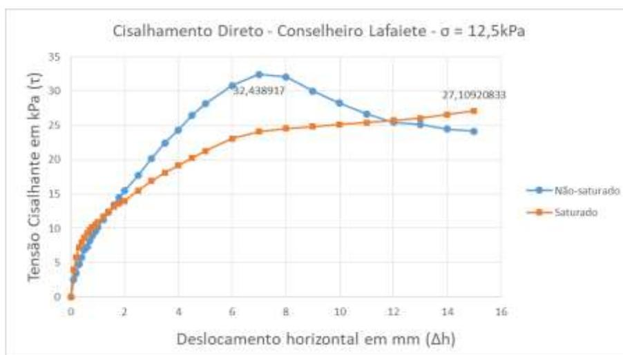
Figura 4.11 - Gráfico da resistência ao cisalhamento do solo, submetido a uma tensão normal de 12kPa.
