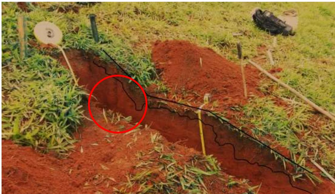
**Figura 4.1** - Perfil da trincheira, com a infiltração do traçador delimitada pela linha negra. Comprimento da fita na parede da trincheira: 35cm. Notar que na berma o traçador infiltrou menos. Conselheiro Lafaiete (Arquivo pessoal).
