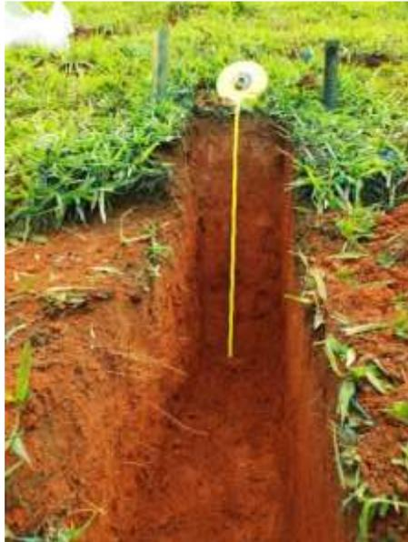
**Figura 3.3** - Abertura de trincheira para análise da infiltração do traçador. Profundidade indicada pela fita métrica: 70 cm. Conselheiro Lafaiete. Arquivo Pessoal.
