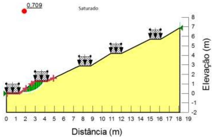
**Figura 4.24** - Análise de estabilidade do terracete inferior (condição saturada); carga distribuída ao longo da largura da bermã.
