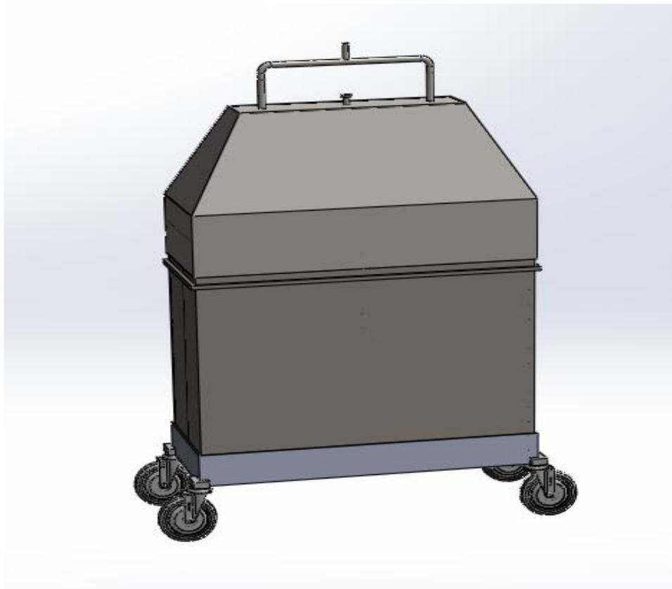
Figura 15: Esboço da caixa de extinção a seco, com a tampa.
