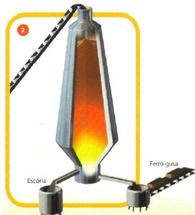
Figura 4: Esboço de um alto forno.
