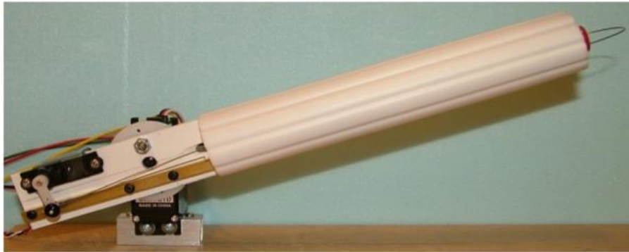
Figura 3 - Manipulador robótico com 1 GDL
