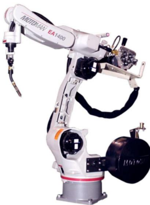
Figura 12 - Manipulador utilizando uma solda como ferramenta em seu efetuador
