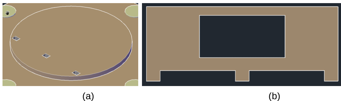
Figura 19 – (a) Base giratória para o suporte do encaixe do suporte (b) base para encaixe do servo
