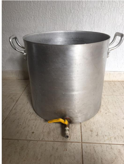
Figura 12 – Foto do caldeirão com a torneira já embutida
