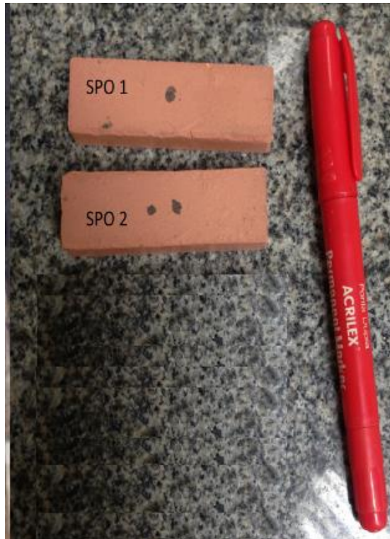
Figura 15: Corpos de prova SPO após queima
