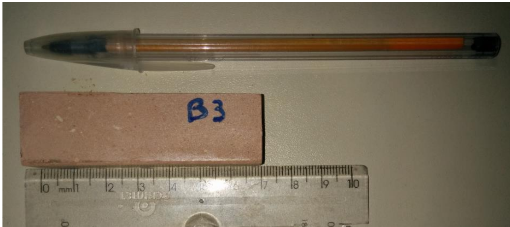
Figura 13: Corpo de prova SP após queima
