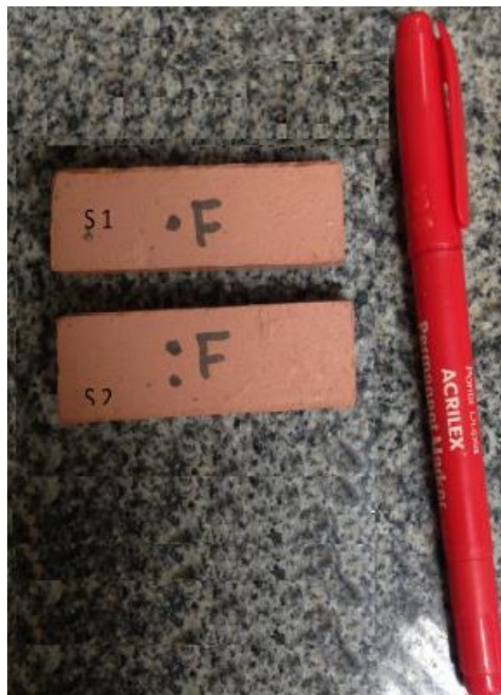
Figura 14: Corpos de prova S após queima
