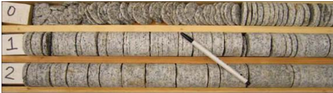
Figura 3.6 - Exemplo da ocorrência de disking em testemunho de sondagem (Lim & Martin 2010)
