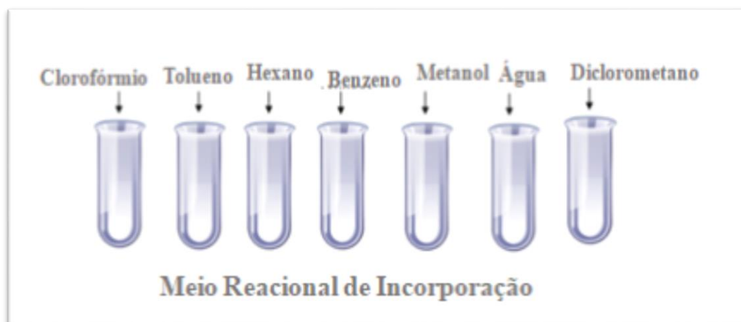
Figura 8: Esquema do Método do Teste de Solubilidade: Derivados do PEG 4000 (acetilado, etilado, halogenado e esterificado) e AAS tiveram suas solubilidades testadas nos meios acima citados.
