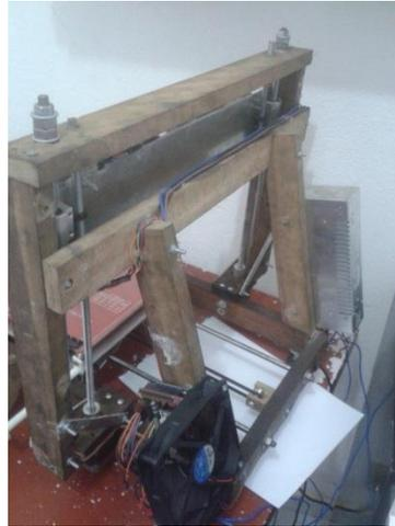
*Figura 6.22 - Reforços da estrutura do eixo Z*
