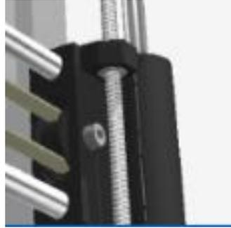
*Figura 6.17 - Projeto original para guia da correia do eixo X*
