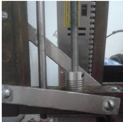
*Figura 6.23 - Reforços de alumínio na base da estrutura do eixo Z*
