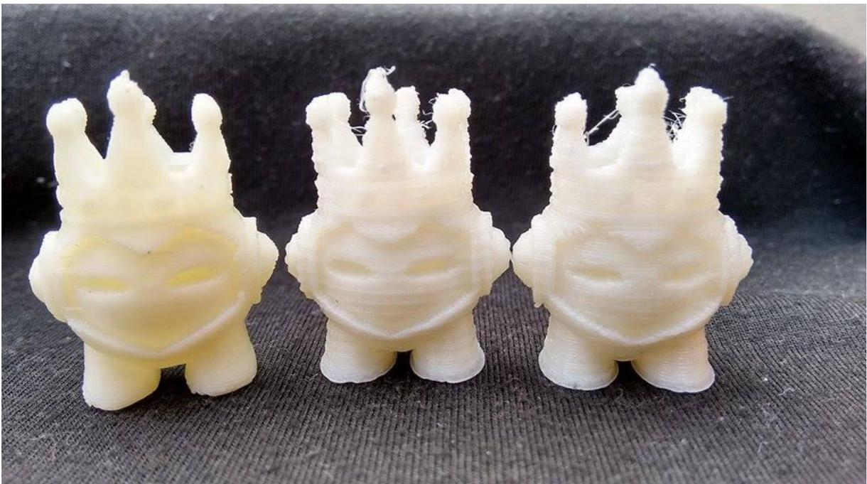
*Figura 7.3 – Peças impressas MakerBot (média), Protótipo (0,2mm) e Protótipo (0,3mm), respectivamente.*
