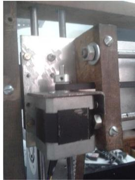
*Figura 6.18 - Nova fixação do motor do eixo X*
