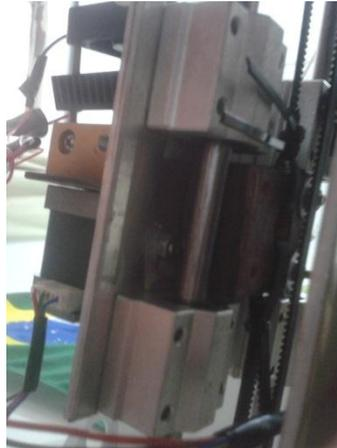
*Figura 6.15 - Novo carro do eixo X*
