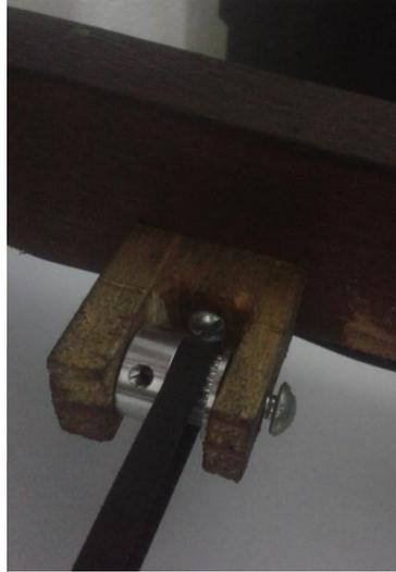
Figura 6.11 - Nova guia para correia do eixo Y
