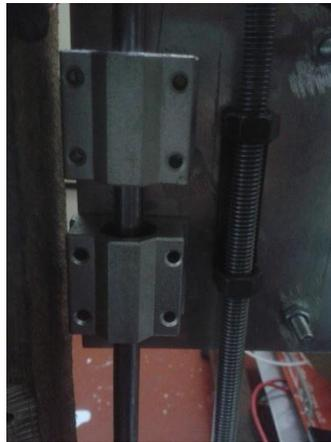
*Figura 6.27 - Fixação Pillow Block e porcas M8*
