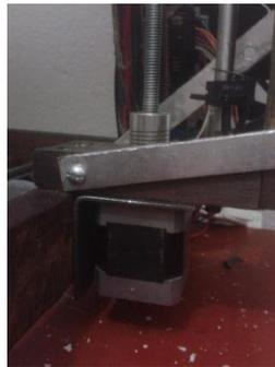
*Figura 6.29 - Nova fixação do motor do eixo Z*
