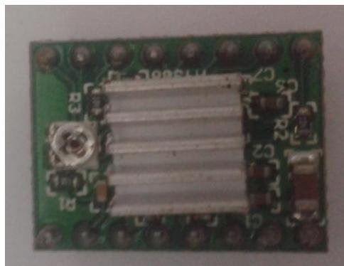
*Figura 4.7 - Driver motor de passo Pololu A4988*
