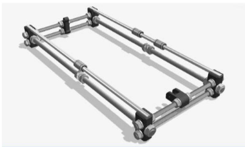
*Figura 6.1 - Estrutura original do eixo Y da Prusa I3
