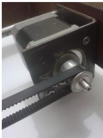
*Figura 6.10 - Nova fixação do motor do eixo Y*
