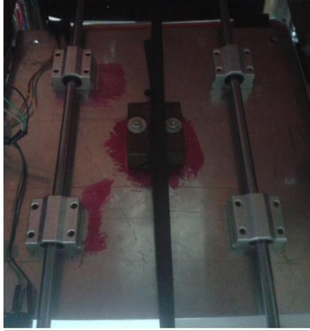
*Figura 6.6 - Fixação dos Pillow Block ao carro do eixo Y*
